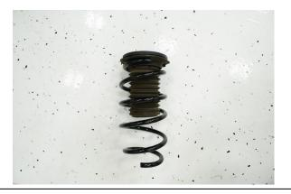
INSTALL FACTIONFAB SPRING ON SHOCK
